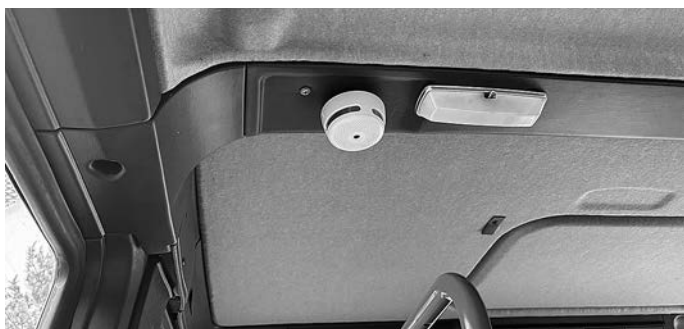
Rauchmelder im Einsatzfahrzeug
